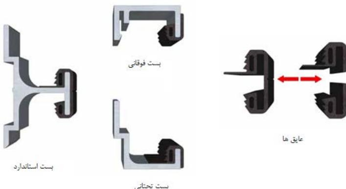
شکل ۷-۵- نصب درزپوش بر روی مهارها
