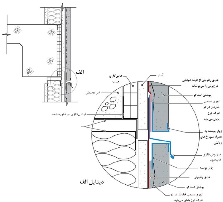
شکل ۶-۳- جزئیات یک نمونه درز انبساط افقی در یک دیوار خشک پوشانده شده از نمای سیمانی
