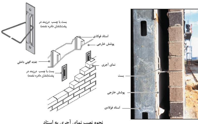
شکل ۵-۲۳-۵- بسته‌های رایج برای اتصال نمای آجری بر روی پشت‌بندهای قائم فولادی (روکش محافظ خارجی فاقد عایق می‌باشد، ولی بین پشت‌بندها از عایق استفاده شده است)
