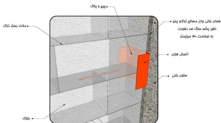
شکل ۱۳-۱۲- مهار دیوار خارجی ساخته شده از بلوک به ستون با استفاده از نبشی یا ناوданی
