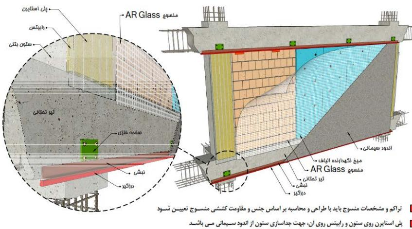
شکل ۱۱-۲۰-۱۱- نمای بتن مسلح شده با منسوج (شبکه الیاف) در دیوارهای نیازمند به عایق حرارتی مانند سفال
