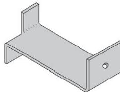
شکل ۷-۴- نمونه‌ای از مهارهای دم دو تکه
