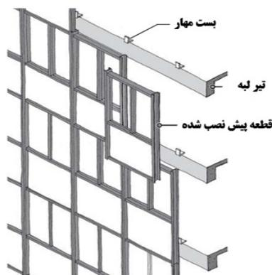
شکل ۲-۹- سیستم نمای پرده‌ای یک پارچه
