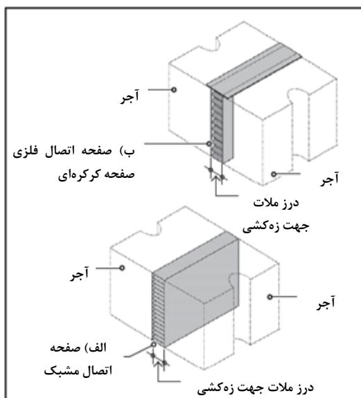
شکل ۱۴-۵- دو نمونه از تورهای محافظ درز ملات خالی
