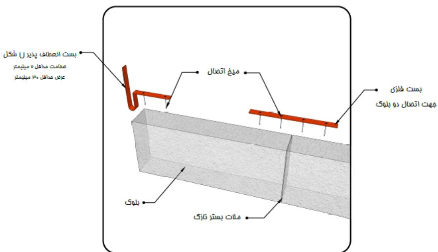
شکل ۶-۱۲- بستهای فلزی منقطع در دیوارهای بلوکی ساخته شده از ملات بستر نازک
