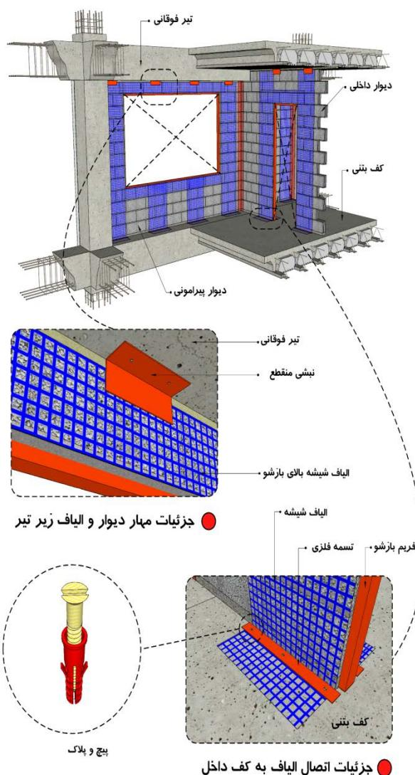
شکل ۲۷-۱۲- تسليح دیوار در مجاورت بازشو با استفاده مش الیاف - وجه داخلی دیوار
