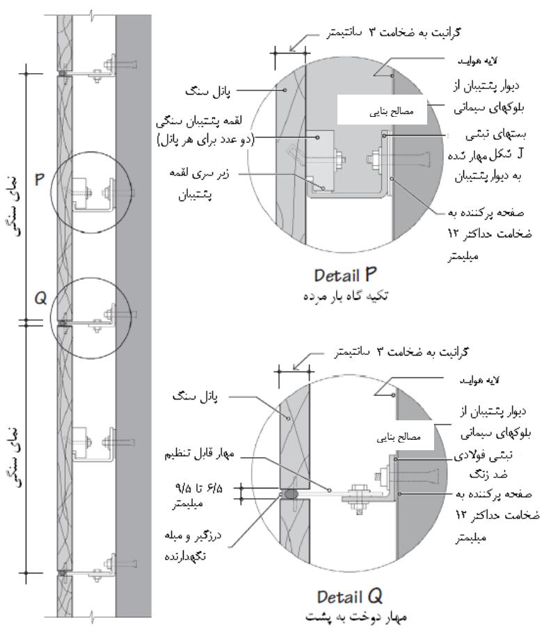
شکل ۴-۶- مقطعی از سنگی از نمای پشتیبان متصل به دیوار بنایی کمک لقمه‌های پشتیبان
