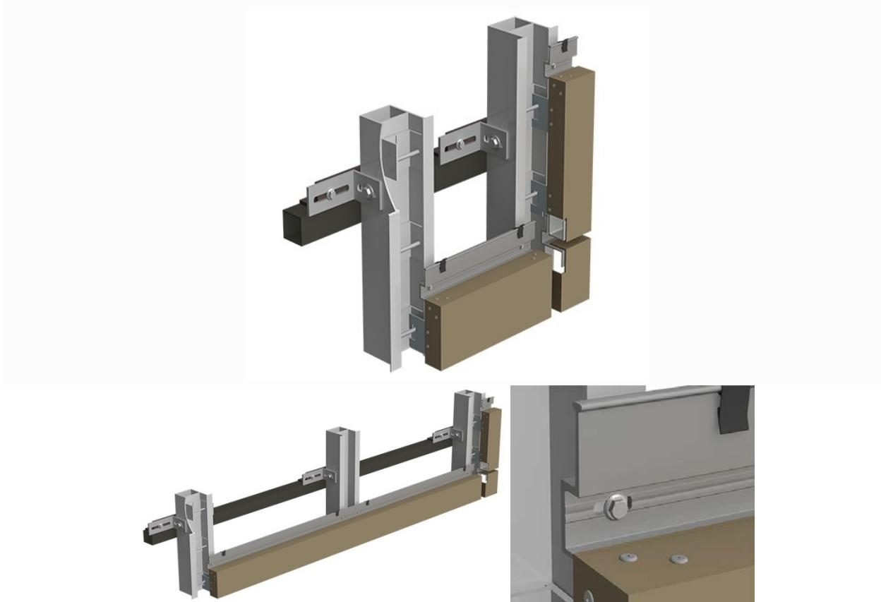
شکل ۸-۵- نمونه‌ای از روش اجرای ثابت - ریلی
