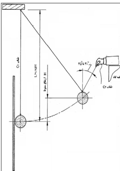
شکل ۳-۱-۳- انجام آزمایش ضربه جسم سخت
