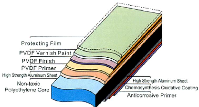
شکل ۱-۸- ساختار لایه‌های پانل
