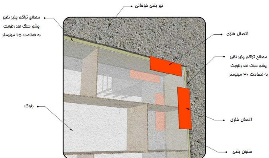
شکل ۱۵-۱۲- جزئیات اجرایی در محل تلاقی دیوار با سقف - اتصال دیوار به سقف با استفاده از نبشی
