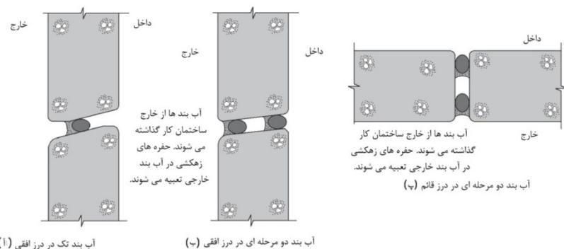
شکل ۱۱-۱۰ نحوه اتصال و عایق‌بندی دیوارهای بتنی پیش ساخته
