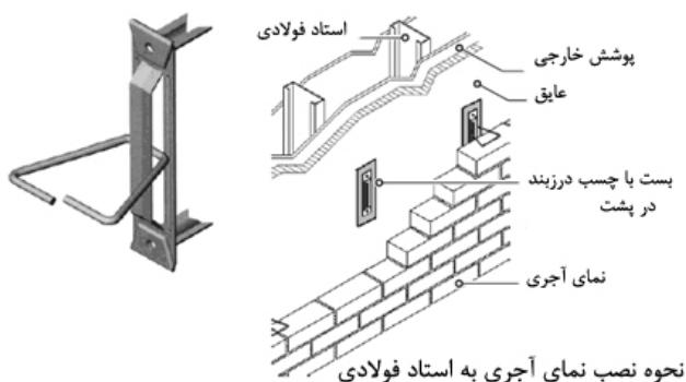
شکل ۵-۲۴-۵- نحوه اتصال نمای آجری به پشت‌بندهای قائم فولادی، زمانی که روکش محافظ خارجی دارای عایق می‌باشد (در این شرایط باید از بستهای زبانه دار استفاده شود)
