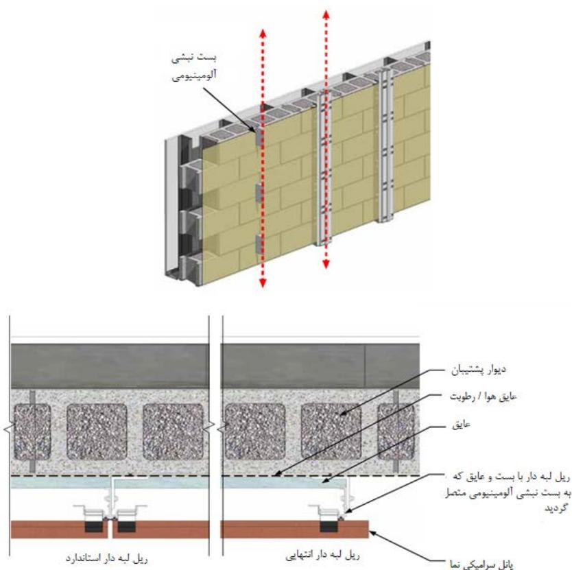
شکل ۴-۷- محل قرارگیری ریل‌های استاندارد و انتهایی و اتصال ریل لبه‌دار به وسیله مهار نبشی شکل آلومینیومی به دیوار پشتیبان
