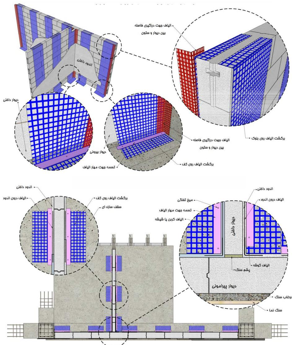
شکل ۱۲-۲۳- نحوه اجرا و تسليح دیوارهای متقاطع با استفاده از مش الیاف
