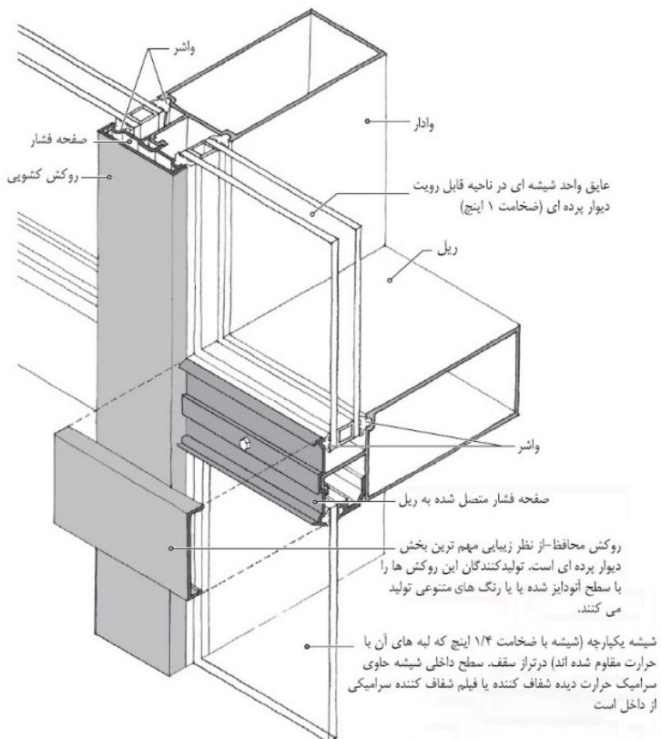
شکل ۱۳-۹- نمای پرده‌ای شیشه‌ای نصب شده از خارج (صفحة تحت فشار نگهدارنده شیشه)
