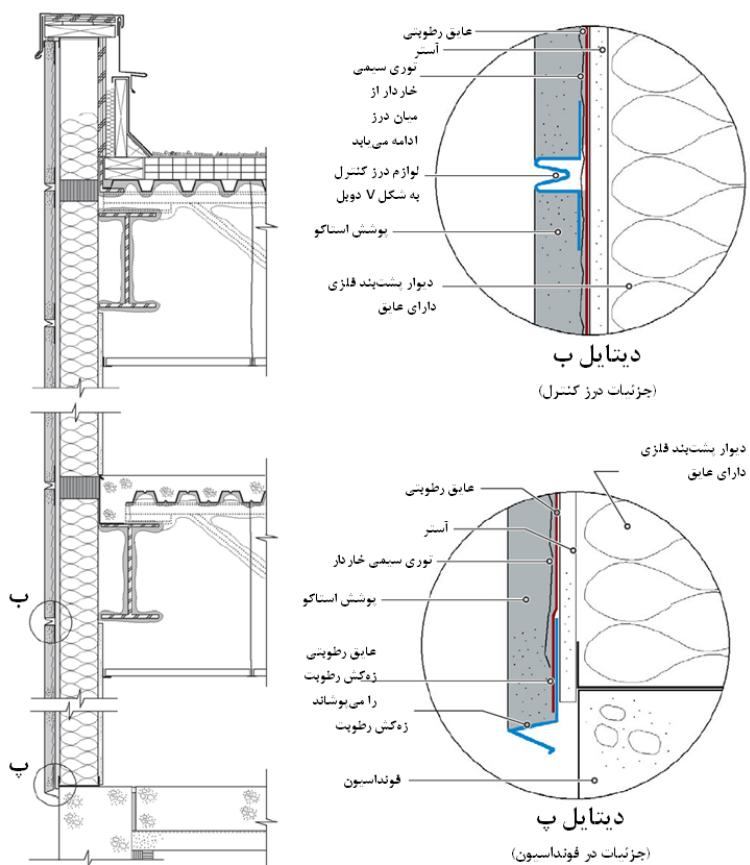
شکل ۶-۶ - یک نمونه مقطع دیوار و جزئیات متناظر از یک ساختمان قاب فلزی پوشانده شده با نمای سیمانی
