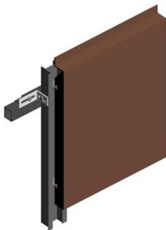
شکل ۴-۸- نمونه‌ای از روش اجرای هوک
