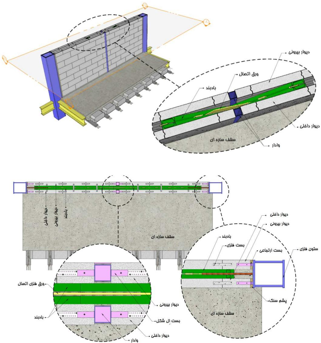
شکل ۱۶- نمونه‌ای از اجرای دیوار با ملات بستر نازک در دهانه مهاربند
