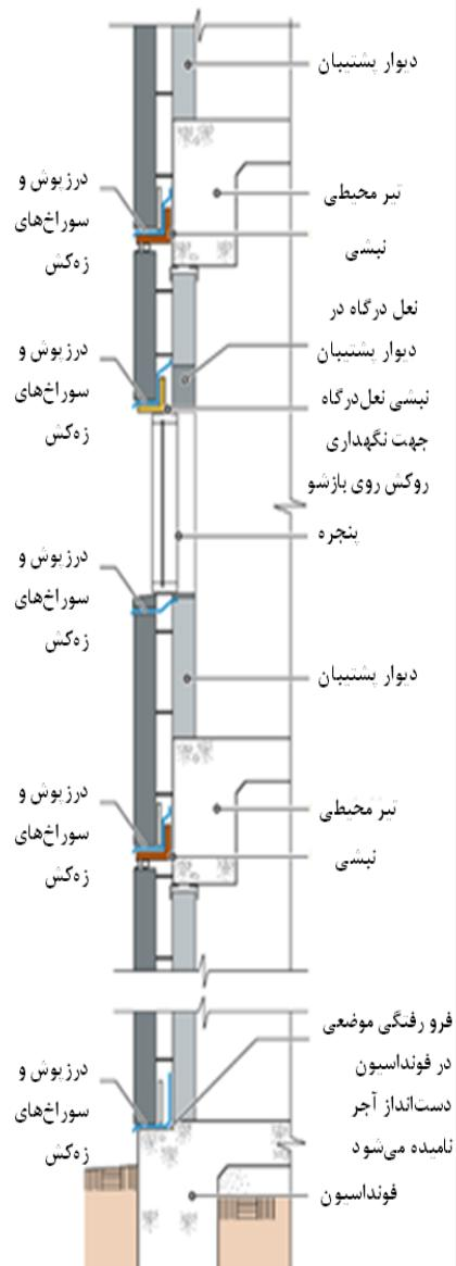
شکل ۱۵-۵ - نمای شماتیک از قرارگیری نبیشی‌های تکیه‌گاهی و نعل در گاهی و درزگیرها
