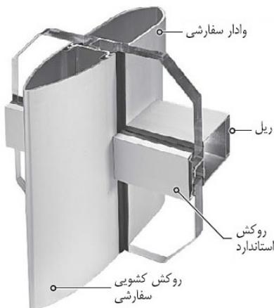
شکل ۱۴-۹- روکش و واذر سفارشی برای نمای پرده‌ای شیشه‌ای با شیشه نصب شده از خارج
