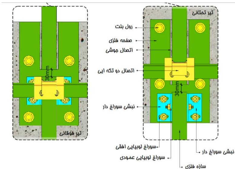
شكل ۴-۱۶- اجرای سوراخ لوبیایی در نبشی اتصال نما خشک برای جلوگیری از انتقال جابجایی نسبی طبقات به نما
