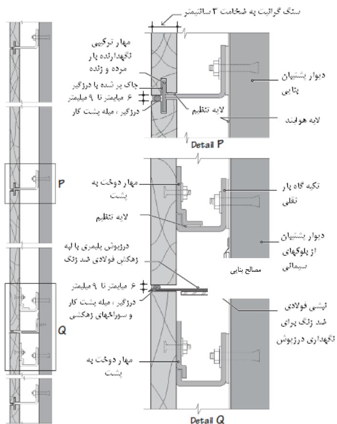
شکل ۴-۱۵- مقطعی از نمای سنگی اجرا شده با مهارهای ترکیبی بار ثقلی و جانبی. شامل ورقه فولادی ضد زنگ.
