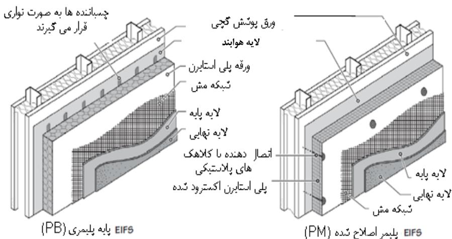
شکل ۱۱-۳-۱- تفاوت بین نما EIFS از نوع PB و PM
