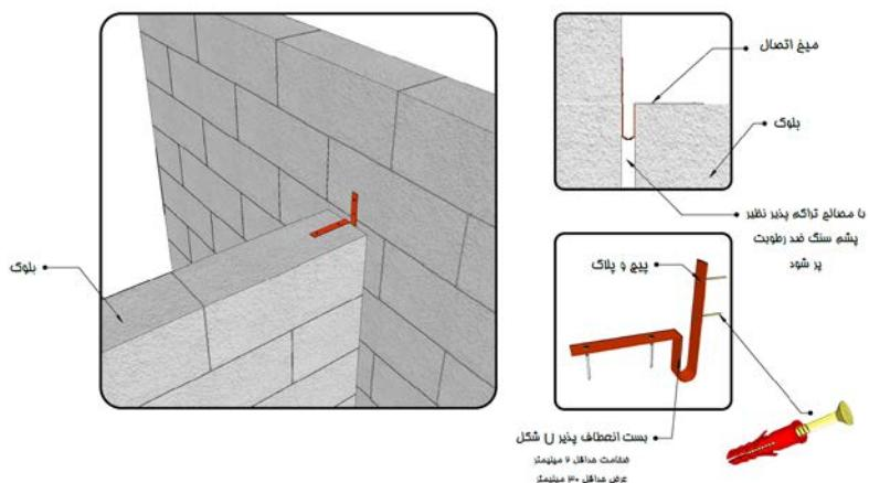
شکل ۱۲-۲۲- اجرای دیوار متقاطع با استفاده از بست اتصالی پذیر
