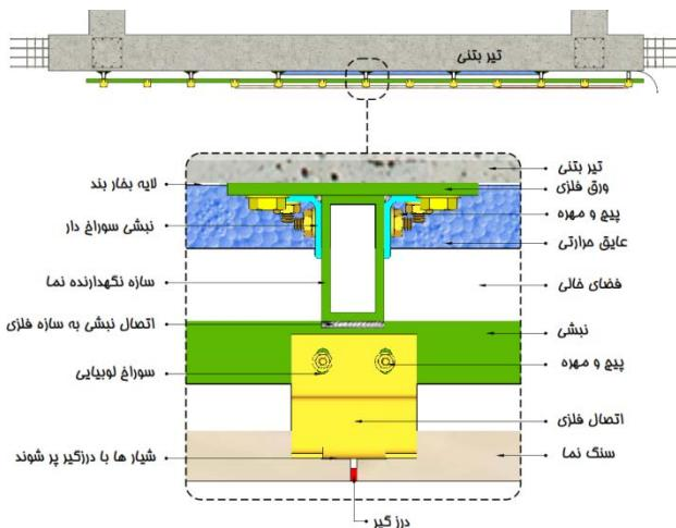
شکل ۴-۱۴- جزییات اتصال مهار سنگ به سازه نگهدارنده نما و تیر بتونی
