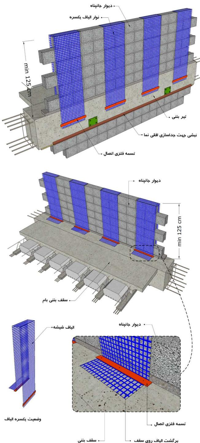
شکل ۱۲-۳۵ - نمونه‌ای از تسلیح دیوار جان پناه با استفاده ملات مسلح شده با مشن الیاف و جزیيات اجرای آن
