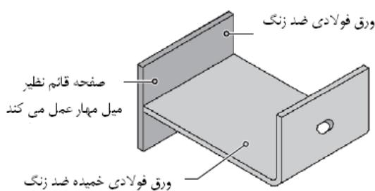
شکل ۹-۴- مهارهای ترکیبی بار ثقلی و جانبی شامل ورقه فولادی ضد زنگ
