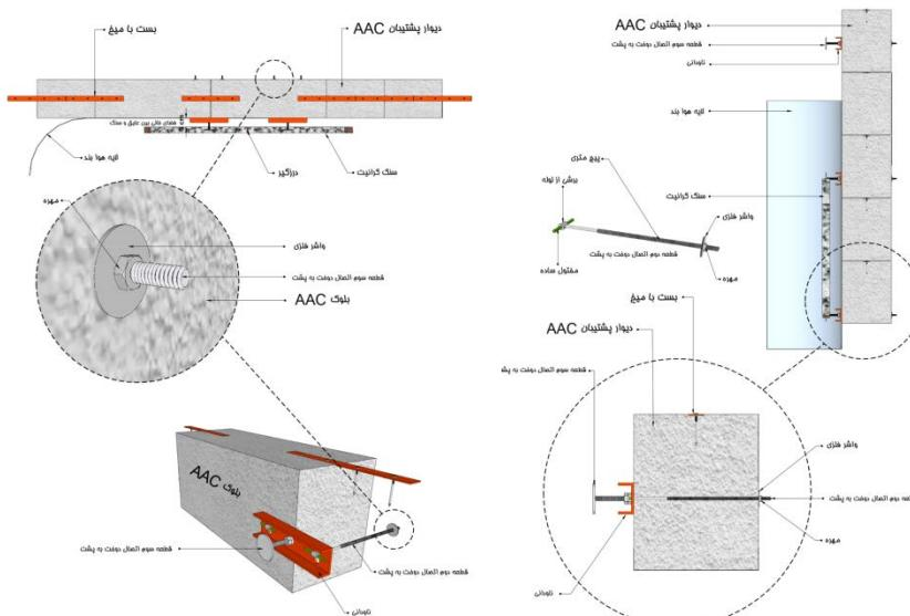
شکل ۱۸-۴ - نمونه‌ای از جزئیات اجرای نمای سنگی خشک بر روی دیوار عایق و مهار آن به دیوار پشتی
