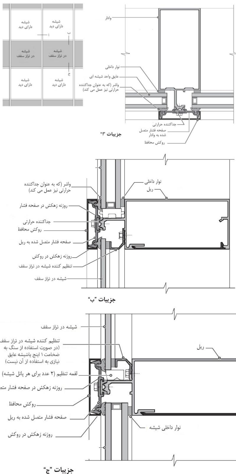
شکل ۹- انواع جزئیات نمای پرده‌ای شیشه‌ای با شیشه نصب شده از خارج (صفحه فشار نگدارنده شیشه)
