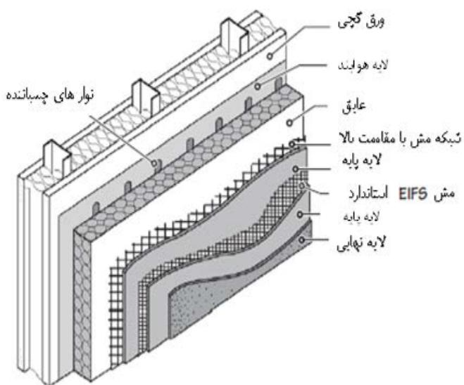
شکل ۱۱-۹ جزییات نمای EIFS مقاوم در برابر ضربه که شامل دو شبکه الیاف است
