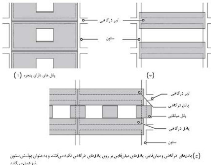
شکل ۳-۱۰- نمونه‌هایی از انواع اشكال پانل‌های بتنی پیش‌ساخته
