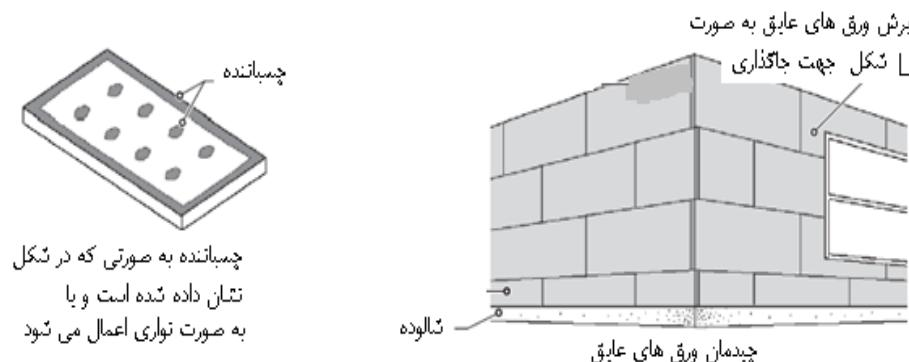
شکل ۱۱-۵-روش‌های مختلف چسباندن عایق به دیوار پشتیبان
