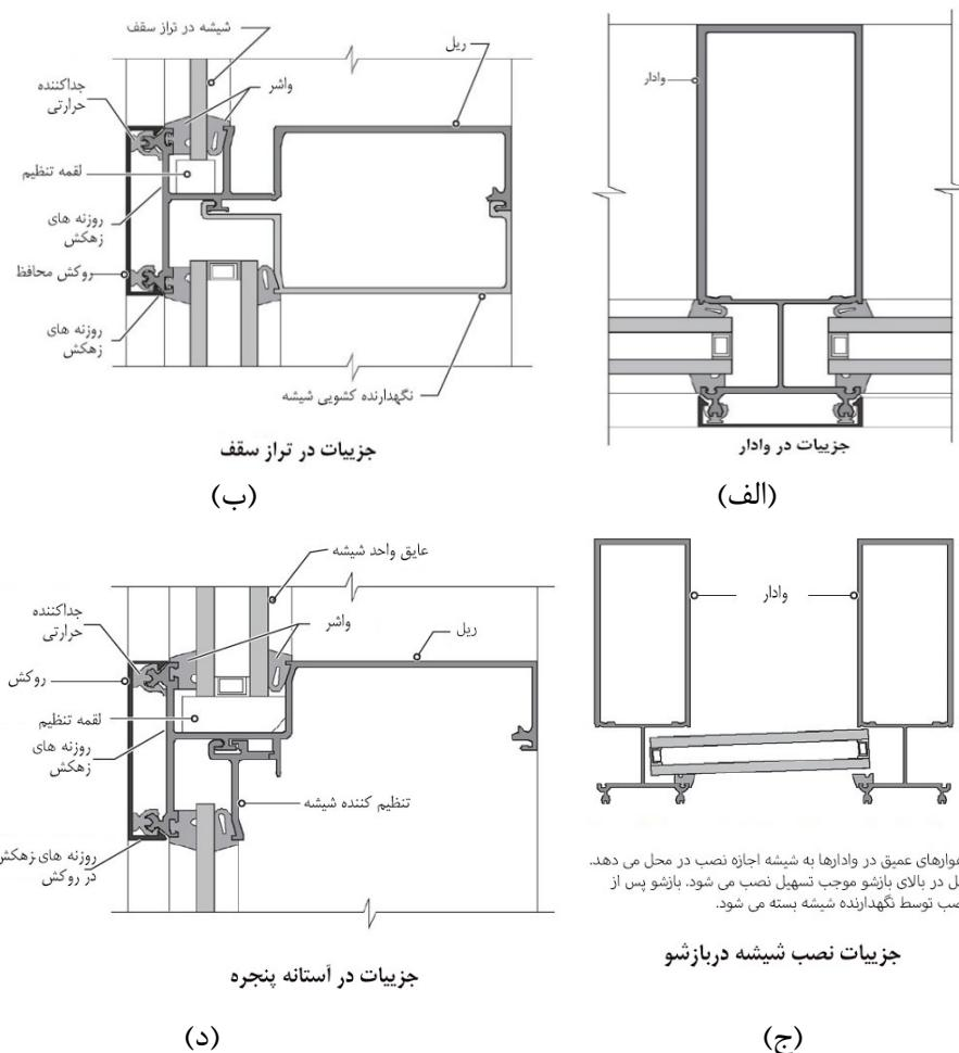
شکل ۹-۱۷-۹- جزئیات دیوار پرده‌ای شیشه‌ای با شیشه نصب شده از داخل
