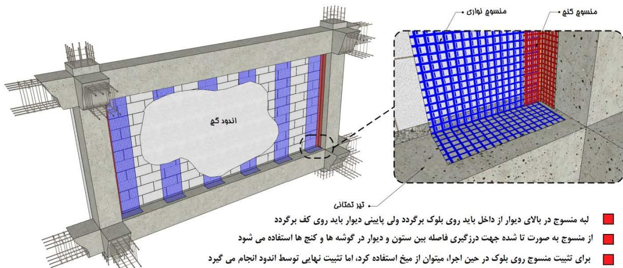
شکل ۱۲-۲۰- مسلح کردن دیوارها با استفاده از نوارهای شبکه‌ای الیاف شیشه (سطح داخلی دیوار)
