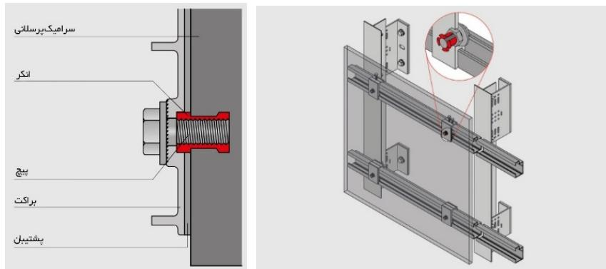
شکل ۱۳-۷- ساختار سیستم نصب پنهان به روش مهار و قلاب
