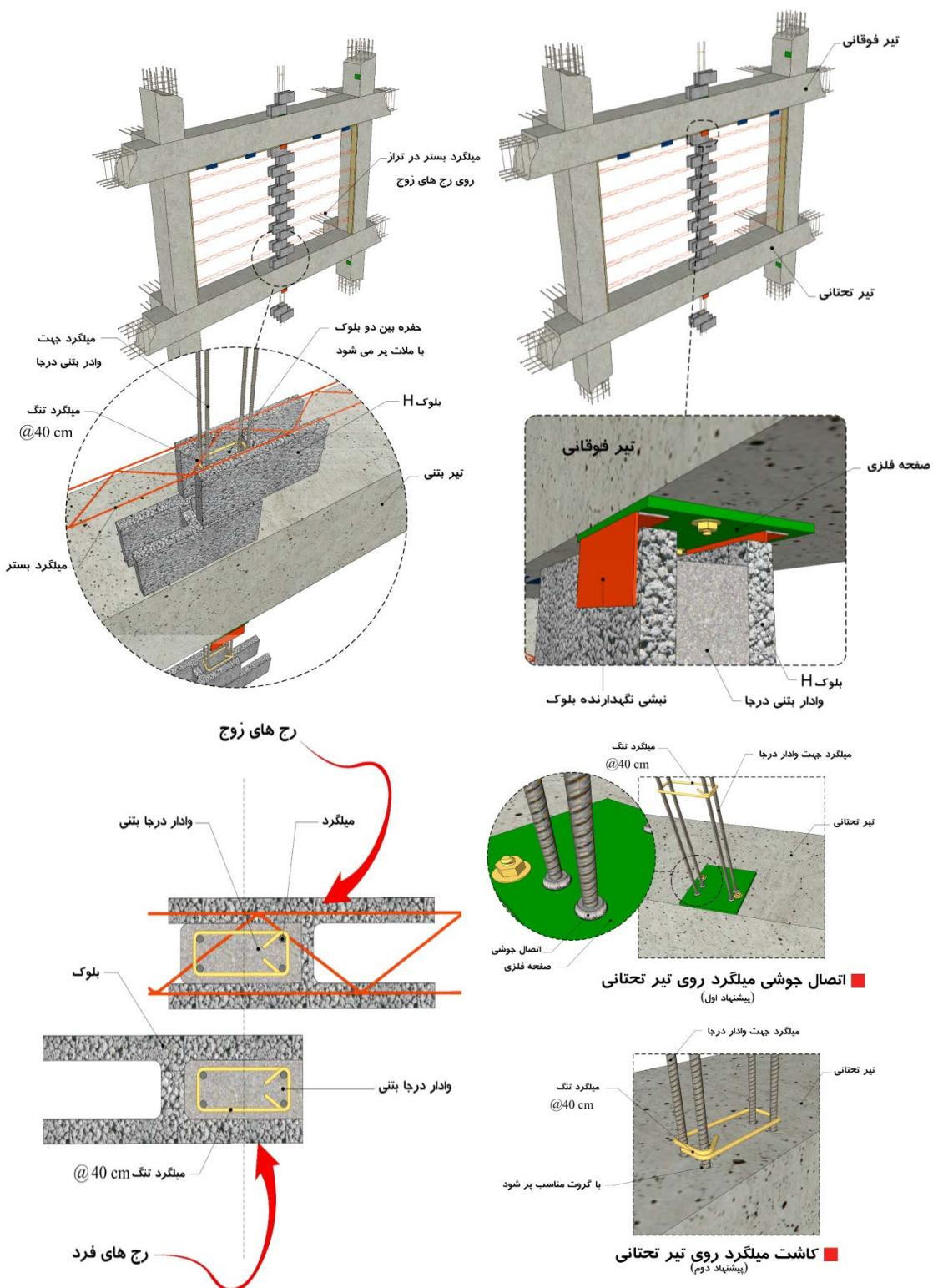
شكل ۸-۱۲- نمونه‌ای از وادر بتُنی و جزئیات اجرایی آن در دیوار بلوکی
