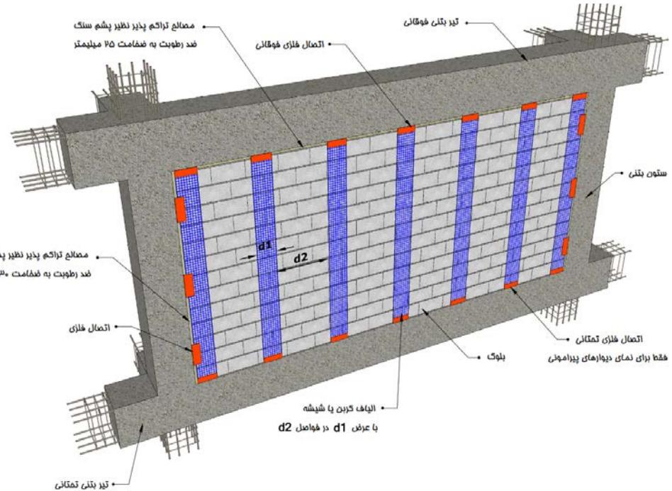
شکل پ-۱۹-۶- مسلح کردن دیوارها با استفاده از نوارهای شبکه الیاف شیشه یا کربن
