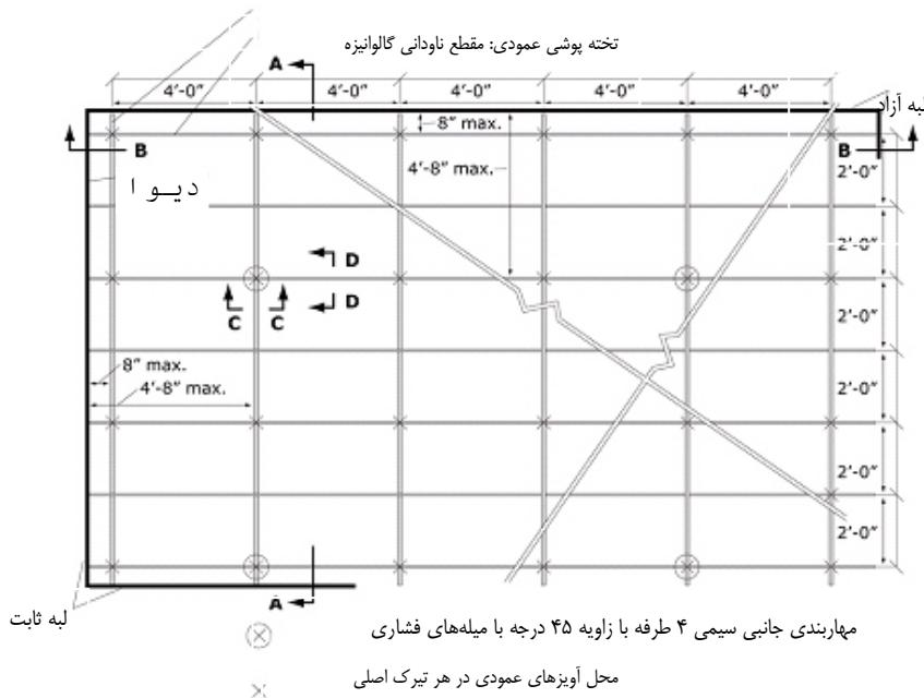
شکل پ-۶-۳۳-۶-پلان مهاربندی عرضی برای شبکه سقف سنگین معلق (جزئیات مقاطع در شکل پ-۶-۲۹ ارائه شده است)
