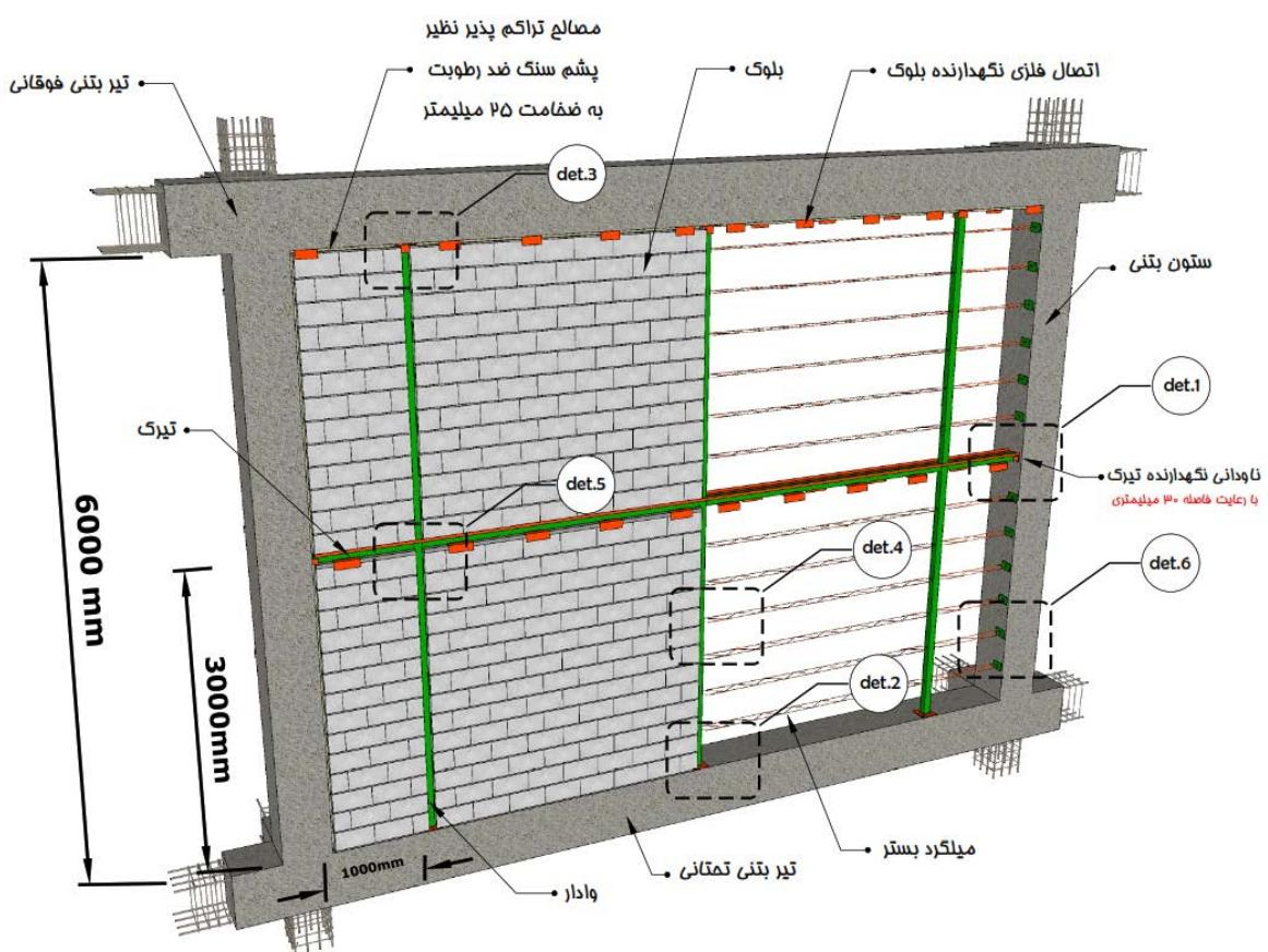
شکل پ-۶-۷- دیوارهای بلوکی با ارتفاع بیش از ۳/۵ متر دارای تیرک و وادر (به عنوان نمونه یک دیوار با ارتفاع ۶ متری)
