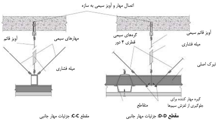
شکل پ-۶-۳۴- جزئیات مهاربندی جانبی برای سقف پانل گچی معلق مقاطع نشان داده شده در شکل پ-۶-۶
