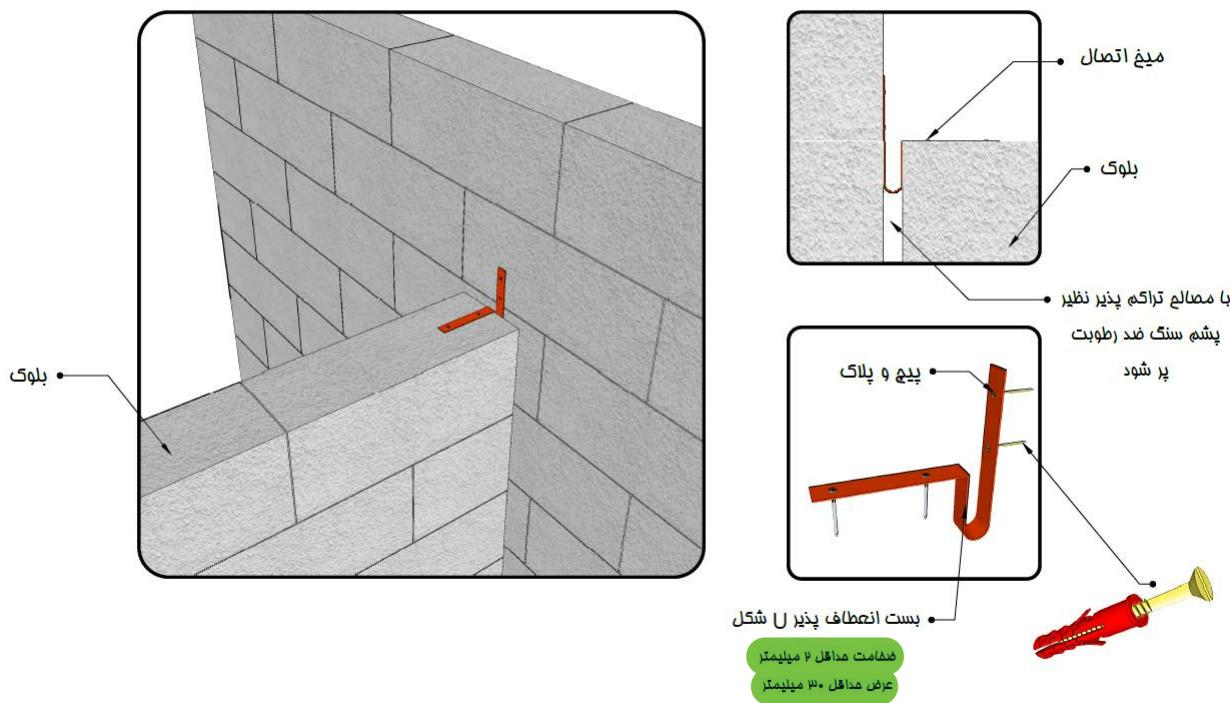
شکل پ-۱۴- اجرای دیوار متقاطع با استفاده از بست انعطاف پذیر
