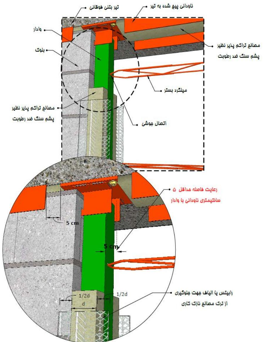
شکل ب-۶- اجرای عایق پشم سنگ و مش الیاف یا رایتیس بر روی وادار
