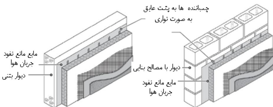
شکل پ ۲۶- نحو صحیح اجرای نمای سیمانی مسلح شده به مش الیاف و عایق حرارتی بر روی دیوار
