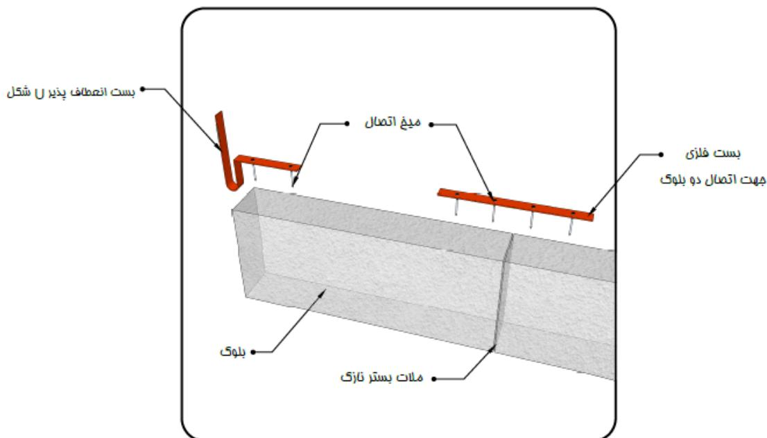
شکل پ-۶-۳- بسته های فلزی منقطع در دیوارهای بلوکی ساخته شده از ملات بستر نازک
