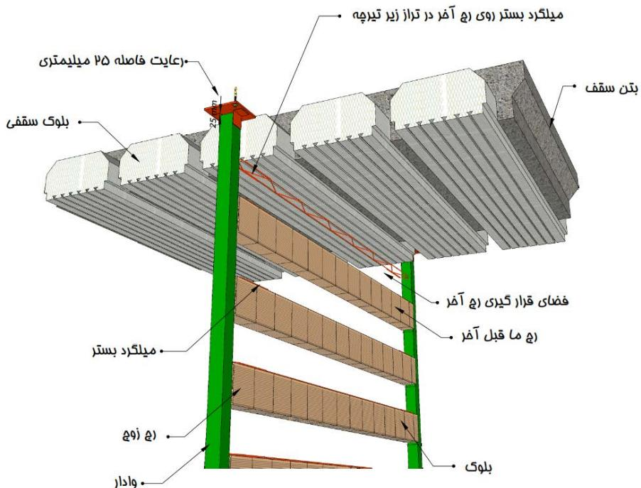
شکل پ-۱۲-۶- مهار دیوار به صورت یک طرفه با استفاده از قطعه مسلح کننده در بالاترین ردیف بلوك مصالح بنایی (اتصال وادر به سقف باید صورت کشویی باشد)
