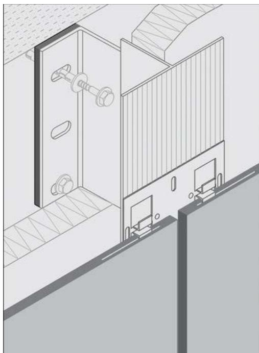
الف- نمونه اجرای اتصال لوبيایی به تیر در اجرای خشک نمای سرامیکی
