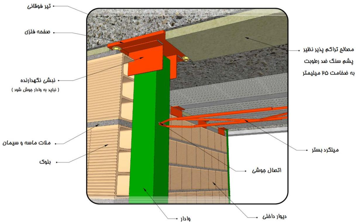
الف- به صورت اتصال کشویی با استفاده از نبیشی
